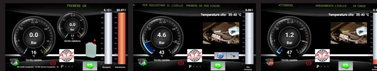
Grazie al database on line e al software di diagnosi l'operatore è facilmente istruito su tutte le operazioni (identificazione del veicolo, giusto accoppiamento, procedure, controlli) e può regolare i principali parametri del cambio.
